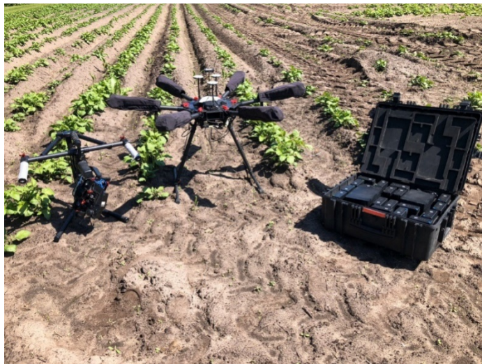
2.1.1 pav. DJI Matrice 600 Pro bepilotis orlaivis naudotas tyrimų metu
