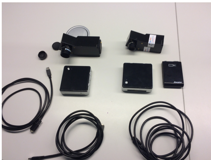
2.1.2 pav. Hiperspektrinės skenuojamojo tipo kameros ir jų komponentai
