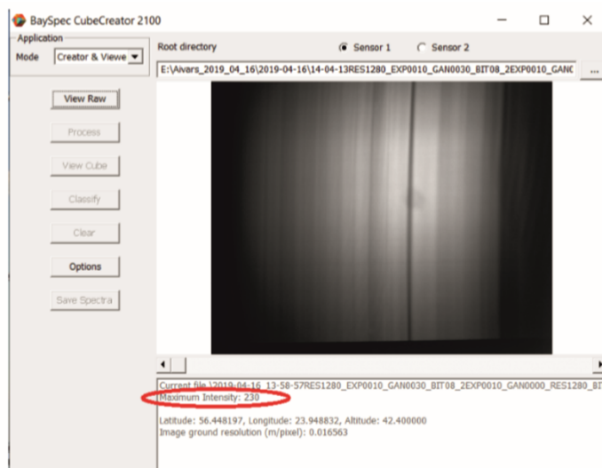
2.4.3 pav. Gerai užregistruotos/ nuskenuotos kalibracinės plokštės ( White reference ) pavyzdys (maksimalus pikselių intensyvumas nesiekia 255) kuomet kalibraciniai parametrai parinkti korektiškai
