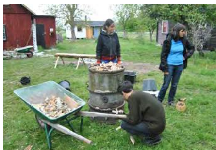
Katilas paruoštas bioanglies gamybai, panaudojant medienos atliekas. Nuotraukos autorius: Jesús Pacheco Justo.
